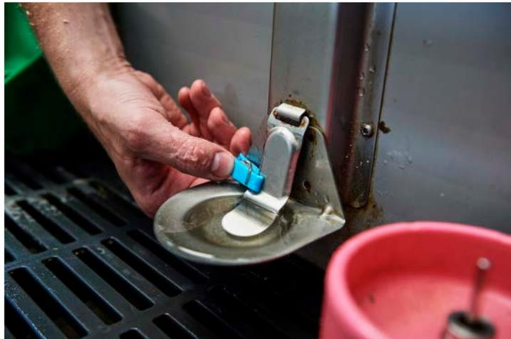
*Al lavar las tuberías, se puede fijar una abrazadera en los bebederos para que siga corriendo el agua*
