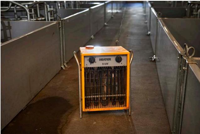
*La desecación se puede llevar a cabo con un calentador eléctrico para asegurar una desecación más rápida y un período más corto en el que el establo está vacío*
